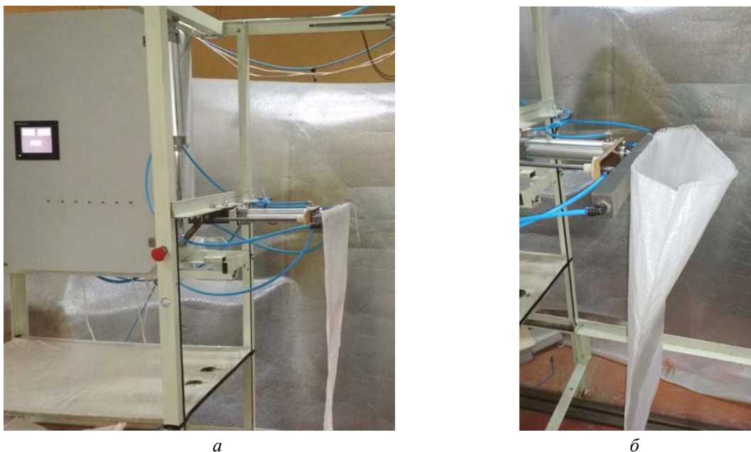
Рис. 2. Опытный образец модульного ВЗУ, изготовленного методом аддитивных технологий: а – ГК захвачен всеми секциями; б – ГК захвачен центральными секциями
